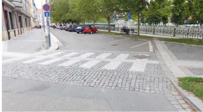
Aufpflasterungen schaffen Aufmerksamkeit für die Querung und verlangsamen den Fahrverkehr.
